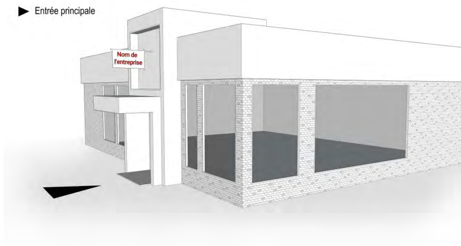
Figure 6 - Démonstration d'une enseigne en projection perpendiculaire
